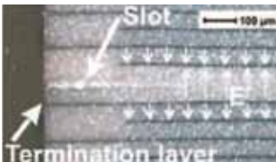
Abb. 46: Deutlich sichtbar ist das patentierte PICMA® Aktordesign mit definierten Schlitzen („Slots“), das unkontrollierte Dehnungsrisse bei dynamischer Ansteuerung verhindert
