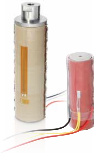
Fertig konfektionierte Stapelaktoren mit Metallendstück und DMS-Ausdehnungssensor (links), mit Anschlusslitzen, Temperatursensor und transparentem FEP-Schrumpfschlauch (rechts)
